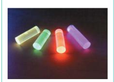
図1 希土類錯体を含む発光プラスチック Figure 1: Luminescent plastic materials with lanthanide
