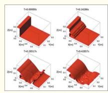
▲越流シミュレーションによる水面の変化
