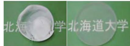
図2 天然で合成される3-ヒドロキシ酪酸をモノマー単位とするポリエスチルのフィルム（左）と人工的に改変した合成系で合成された乳酸を含むポリエスチルの透明フィルム（右）。乳酸のフィルム（右）では、背景の文字をはっきりと読むことができる。
