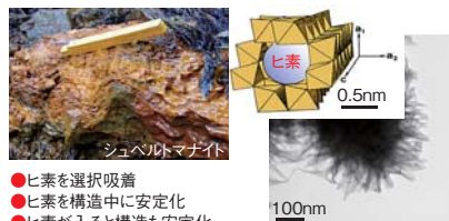
図1 天然に産するシュベルトマナイトの特性、構造、形態 Figure 1: Characteristics, structure and morphology of natural schwertmannite
