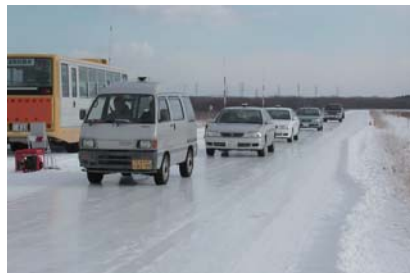
図1 冬期のツルツル路面での走行試験 (車の屋根にあるのがRTK-GPSアンテナ)
