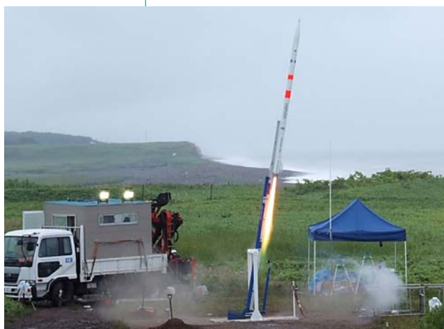
図1 推力250kgf級CAMUI型ハイブリッドロケットの 打上げ実験（2007年8月）
