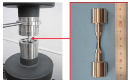
図1 疲労試験機に取り付けられた原子力配管用ステンレス製テストピース(SUS316NG)
