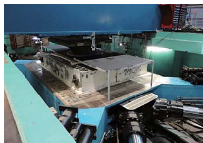
図3 実大免震積層ゴム的高速載荷試験 (カリフォルニア大学サンディエゴ校)
