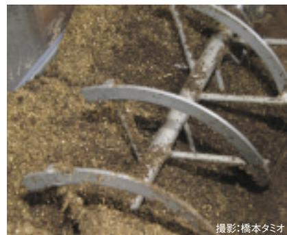
図1 トイレに設置したコンポスト反応槽
