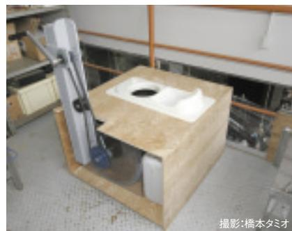
図2 子供でも自力で使える利便性を追求したし尿分離式便器と手回し装置
