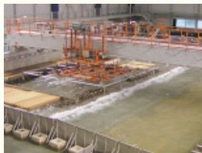
▲3次元波浪実験による海岸地形変化実験(砂の移動実験)
