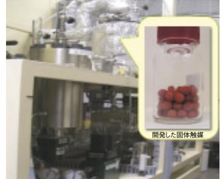
図1 ベンチスケールの触媒反応装置
