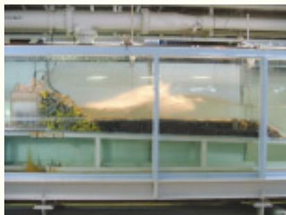
▲2次元波浪実験による港湾構造物の安定性・消波性能確認試験
