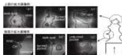
図2 計測結果の一例 （乱流予混合火炎：右側がアセトン＜未燃側＞、左側がOH＜既燃側＞）
