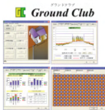
図1 当研究室が開発した地中熱ヒートポンプシステム性能予測プログラム“Ground Club”
