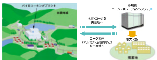
図2 PC法を使ったエネルギー利用システムのイメージ
