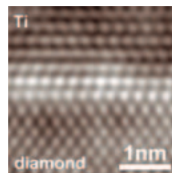
▲図 高分解能電子顕微鏡で撮影したダイヤモンド薄膜／Ti電極界面における原子配列の写真
