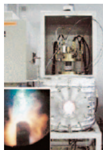
▲図2 プラズマ装置(右)と窒素熱プラズマ状態(左下)の写真
