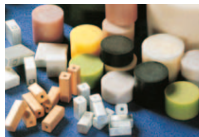
▲図 種々のマイクロ波誘電体共振器の写真
