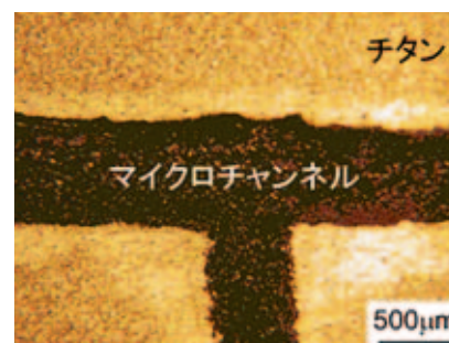
▲図 チタン中に形成したT字状マイクロチャンネルの写真
