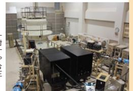
▶電子、イオン、レーザーを同時に照射して材料・物質のナノレベルの観察や解析が出来る複合量子ビーム超高压電子顕微鏡
