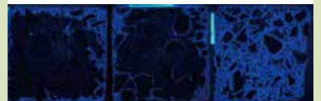
▲可視化手法による凍結融解におけるコンクリートのひび割れの進展
