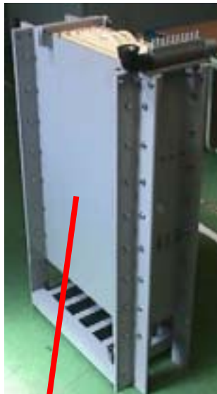
Membrane Module (10 elements)
