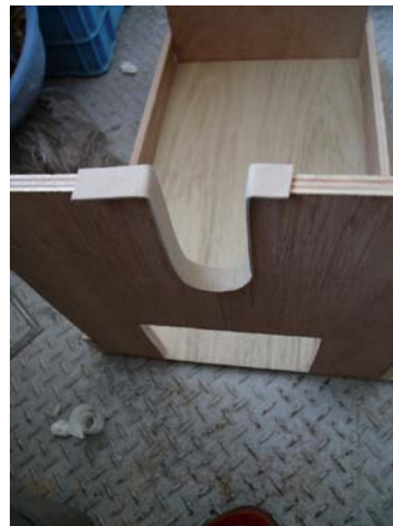
パイプが乗る凹みに貼る。
